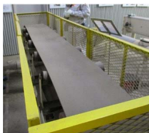
ベルトコンベア危険体感機
